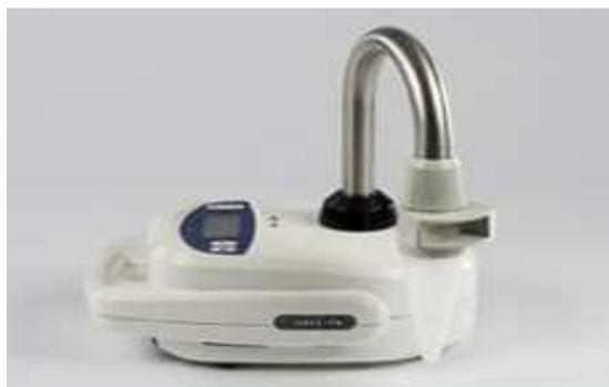
Au moyen de cette technique cyclonique, sur chaque point de mesure furent envisagés initialement deux prélèvements de 5 min à 100 L/min (paramètres affinés pendant l'étude de variabilité dédiée selon les typologies de sites de mesure). Chaque prélèvement fût réalisé sur un support de prélèvement liquide différent (liquide de collection standard et eau apyrogène) afin de caractériser les différents paramètres microbiologiques et les endotoxines.
