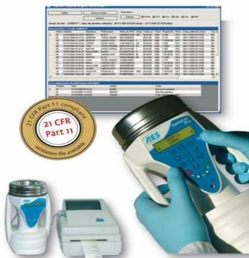
Sur chaque point de mesure, deux prélèvements d'air par impaction de 5 min à 100 L/min, furent envisagés initialement (paramètres affinés pendant l'étude de variabilité dédiée selon les typologies de sites de mesure) chacun sur un milieu de culture différent (PCA et OGA) afin de caractériser les paramètres fongiques et bactériens.
